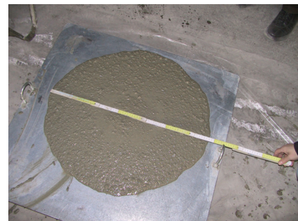
elevato spandimento rilevato con lo slump test
