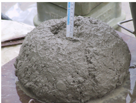
Hydrobeton allo stato fresco si presenta molto denso
