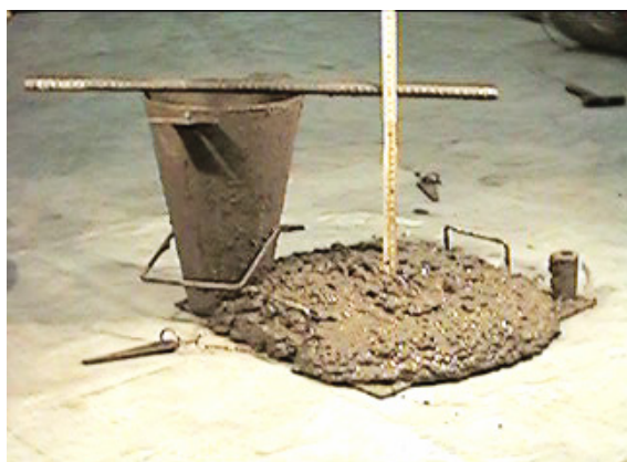
Consistenza S5 slump > 220 mm
