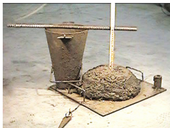
Consistenza S4 slump 160 - 210 mm
