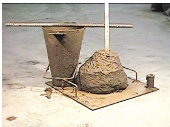
Consistenza S3 slump 100 - 150 mm
