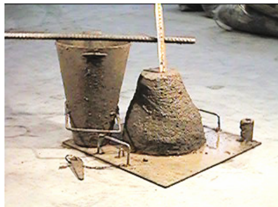
Consistenza S2 slump 50 - 90 mm
