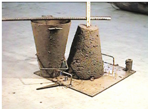
Consistenza S1 slump 10 - 40 mm
