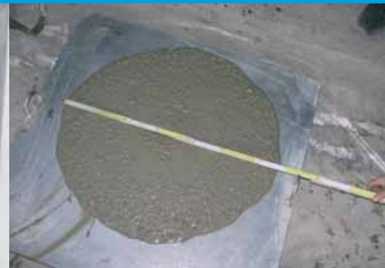
Elevato spandimento rilevato con lo slump test
