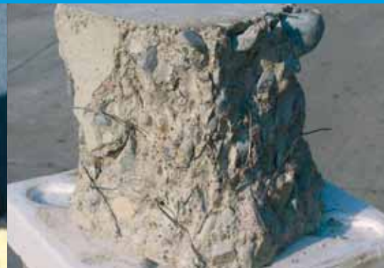
Fibermixbeton allo stato indurito
